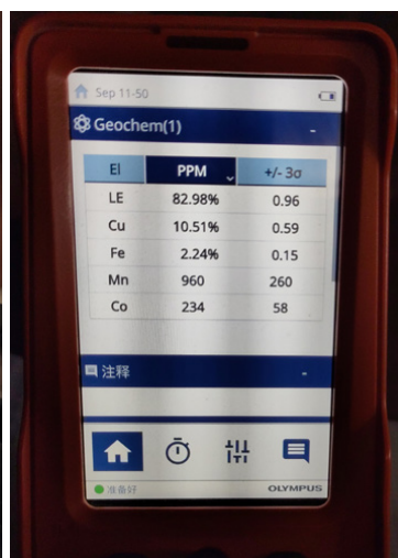
▲ (Deux photos) : Spectromètre utilisé pour mesurer la teneur en métaux du minerai extrait.
