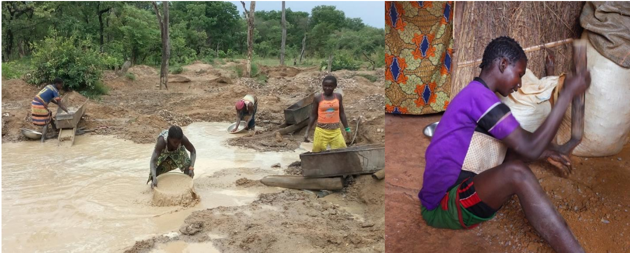
Photos 5 et 6 : Lavage et traitement de l'or par les femmes sur le site de Miskine. Concassage du gravier près du site de Gbonkolo.
