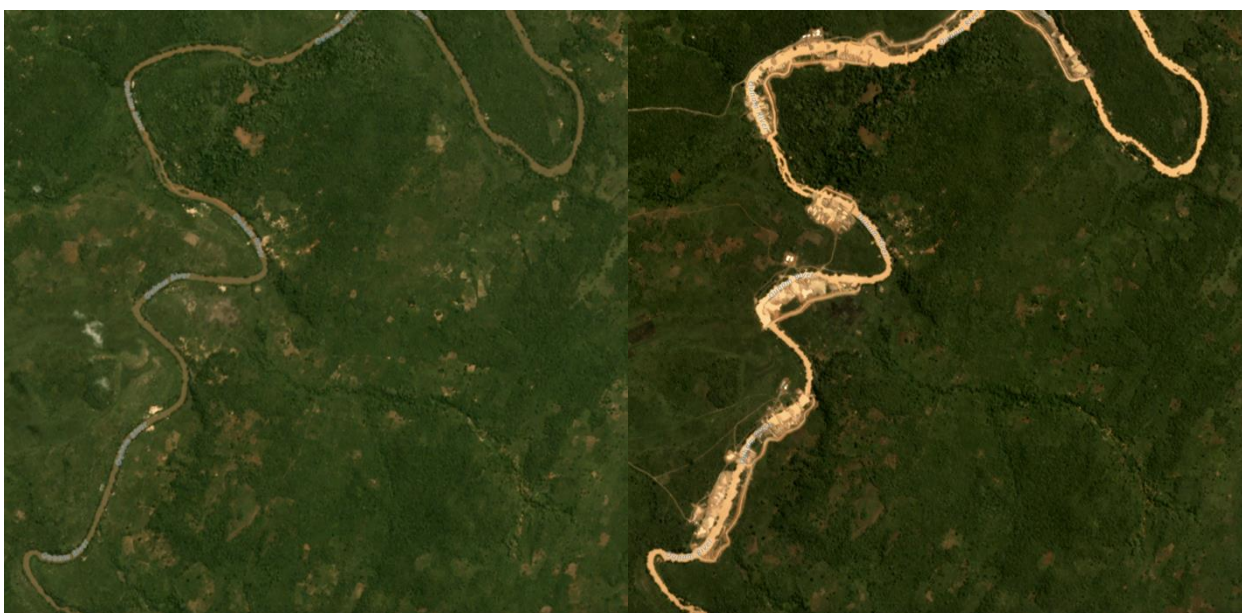
Photos 43 et 44 : Images satellite de Bozoum (vue rapprochée) prises en juin 2018 et en juin 2019. Sur ces images les canaux de détournement de la rivière ainsi que les piscines de décantation sont clairement visibles.
