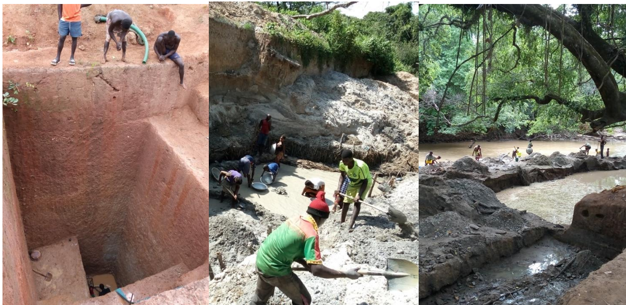
Photos 8, 9 et 10 : Exploitation d'un puit sur le site de Yakouma, exploitation en terrasses ouvertes sur le site de Ban Camp-Bangui et dans le lit de la rivière sur le site de Ban Zoué.
