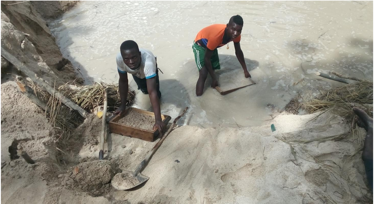
Photo 28 : Tamisage du gravier sur le site diamantifère de Kolongo.
