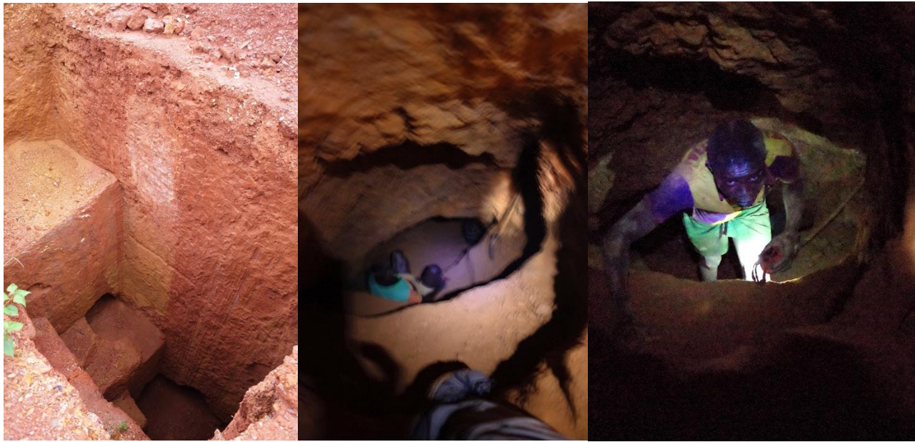
Photos 11, 12 et 13 : Sur le site de Gbonkolo, les puits peuvent atteindre plus de 15 mètres de profondeur. Du fond des puits partent des galeries non étayées qui suivent la veine de gravier sur plusieurs mètres.
