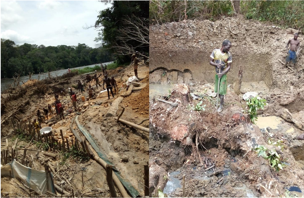
Photos 36 et 37 : Utilisation de motopompes pour assécher la berge de la rivière sur le site diamantifère de Zingawe-Lobaye. L'artisanat minier demande parfois une longue phase de découverte causant un important déboisement, ici sur le site de Yewere.
